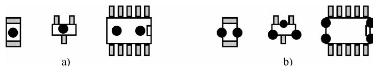
Obr.3.9: Lepící body při vytvrzování teplem a) a ultrafialovým zářením b).
